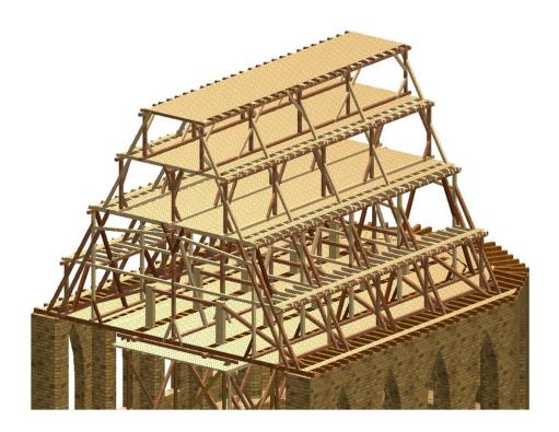
**Die Sparrenmontage.**Die 27,5 m langen Sparren wurden aufgestellt und aufgezogen. Am unteren Ende wurden sie auf die Balken aufgesetzt und dann in die ausgeformten Kehlbalken mit Schwalbenschwanzblättern verbunden.
