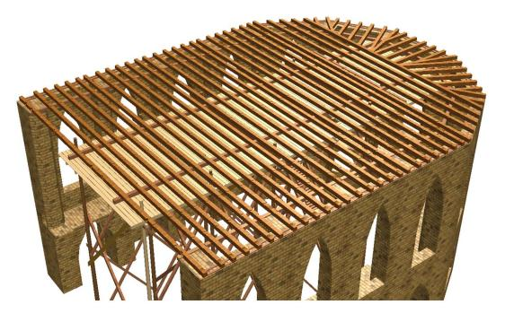
**Aufrichten des 10 m hohen Längsverbandes.**Mit Fußstreben von Innen und Doppelstreben von Außen wurde ein sicherer Längs- und Querverband hergestellt.
