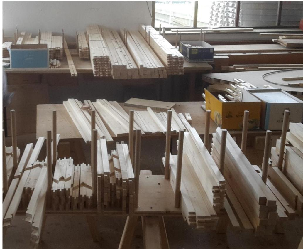
Die Balken- und Kahlbalken mit Schwellen und Pfetten sind fertig eingepasst und müssen bis zur endgültigen Montage wieder zwischengelagert werden.
